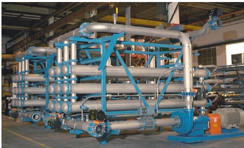
Figura 10. Ultrafiltración con membrana espiral. Por cortesía de AQUAESPaña
